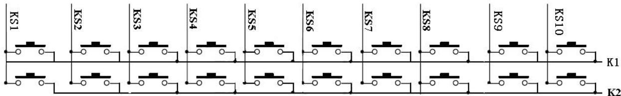
键扫数据储存地址如下所示，先发读键命令后，开始读取按键数据 BYTE1—BYTE5 字节，读数据从低位开始输出，其中 B6 和 B7 位为无效位，此时芯片 K 和 KS 引脚对应的按键按下时，相对应的字节内的 BIT 位为 1。
