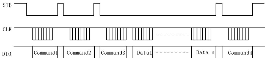
Command1: 设置显示模式。显示模式的设置在上电后设置，一般只需要设置一次就可以了。
